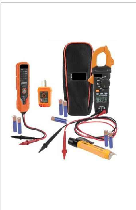
Descripción: Multímetro de gancho CL120 que mide corriente CA con las pinzas, así como voltaje CA/CD, resistencia y continuidad con cables de prueba
